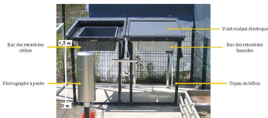
Figure 1. Prototype d'échantillonneur des retombées atmosphériques sèches et des eaux météoriques installé à Chassieu (ici en position temps sec)
